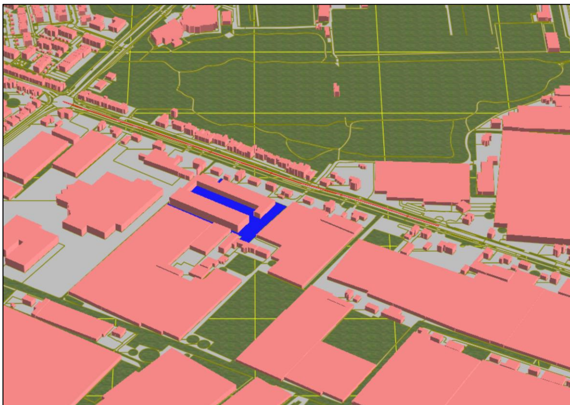
Afbeelding 1 : 3D-afbeelding rekenmodel wegverkeerslawai.
