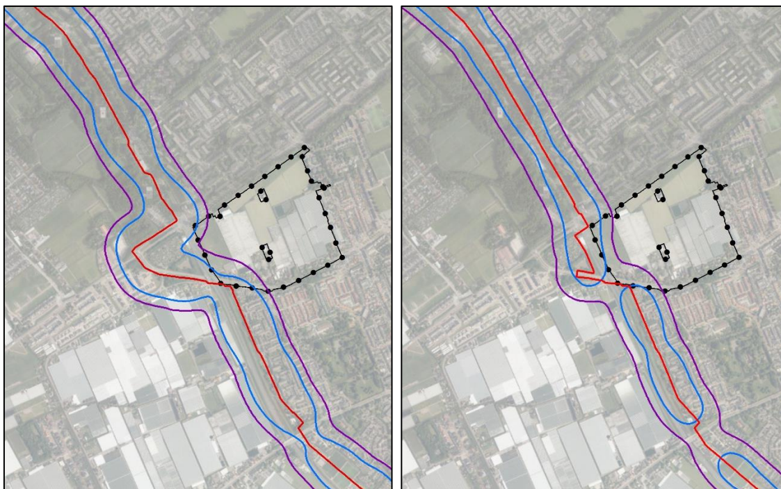
Afbeelding 4.3: Plaatsgebonden risico voor gasleiding A-617 (links) en W-509-02 (rechts) - blauwe contour = PR 10^{-7} en paarse contour = PR 10^{-8}
