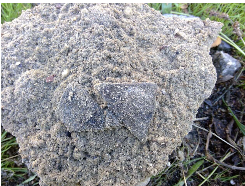
Sleuf 3 (asbestplaatje onderzijde betonvloer)
