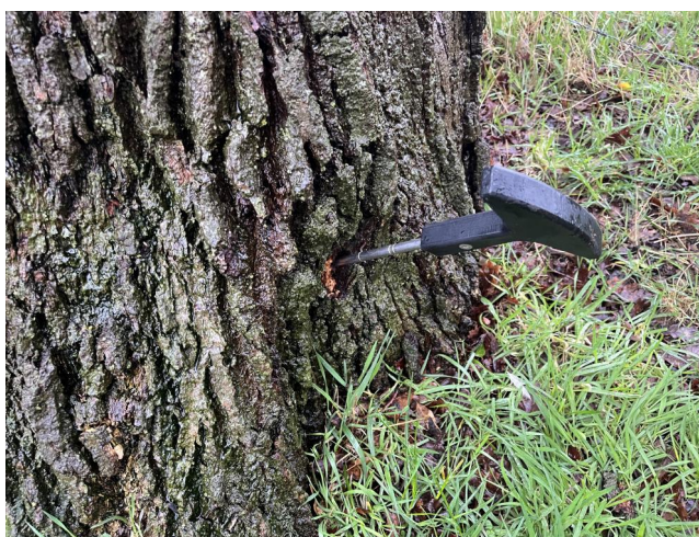
3.1.2 - Omvangrijke rotting in de stamvoet van boom 6
