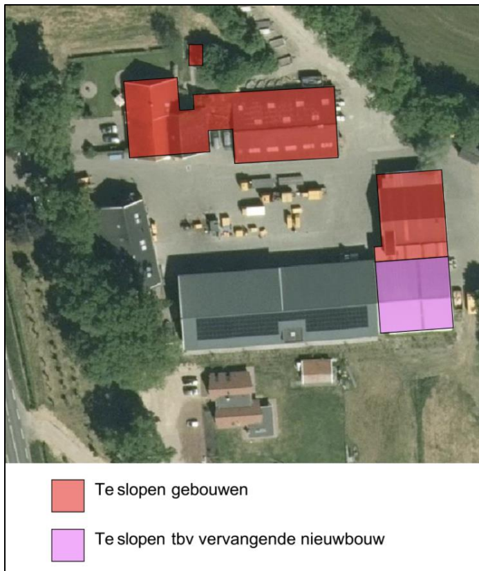
Afbeelding 2.2 Te slopen bebouwing (Bron: NK Bouwbegeleiding)
