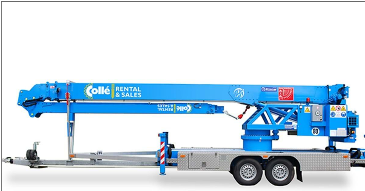
Voorbeeld van een lichte, mobiele kraan. Geschikt voor o.a. het aanreiken van dakpannen, kozijnen en glas.
