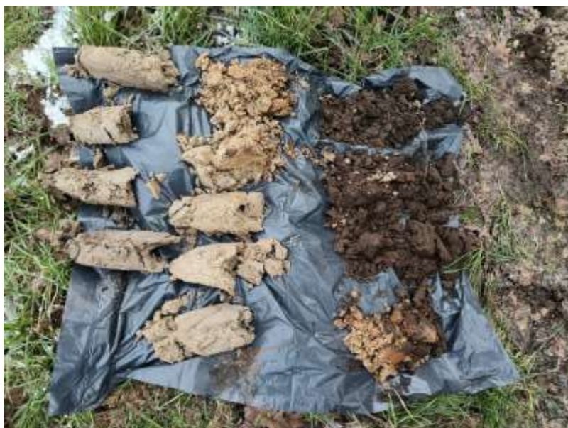
Figuur 5. Het resultaat van de grondboring tot 120 centimeter uitgevoerd in het zuiden van het perceel. De bovenste 35 centimeter van de bodem bestaat uit sterk lemig zwart zand. Daaronder bestaat de bodem uit leemarm grijs zand met roest vlekken. Vanaf 90 centimeter is de bodem zeer vochtig. De pH van de bodem is tot 80 centimeter 5 en daaronder is de pH 5,5.
