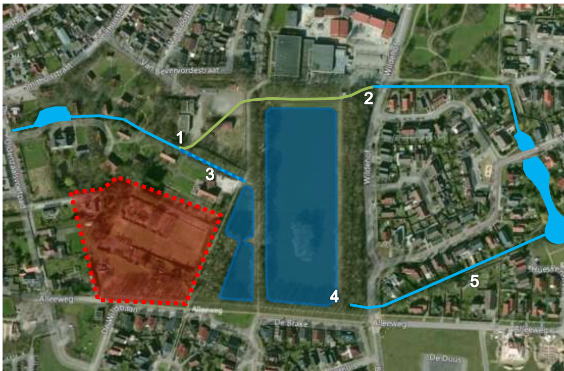
Figuur 2: Nieuw tracé Molenbeek (lichtgroen), de Commanderie (rood) en de vijvers (donkerblauw) Het nieuwe beektracé start bij (1) en stroomt via de noordzijde langs de grote vijver. Vervolgens vindt de aansluiting plaats bij (2) op de bestaande beek. Het oude tracé (3) wordt als aflaat gebruikt om onder extreme omstandigheden water van de Molenbeek in de vijver te kunnen laten stromen. De aflaat in de zuidoosthoek van de vijver (4) blijft gehandhaafd, om het vijverpeil te kunnen beheersen en water af te kunnen voeren in noordoostelijke richting (5).
