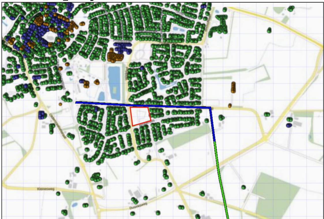
Figuur 4.4 Kilometer leiding behorende bij de maximale overschrijding van de FN-curve voor 7177_leiding-N-531-91-deel-1 van N.V. Nederlandse Gasunie
