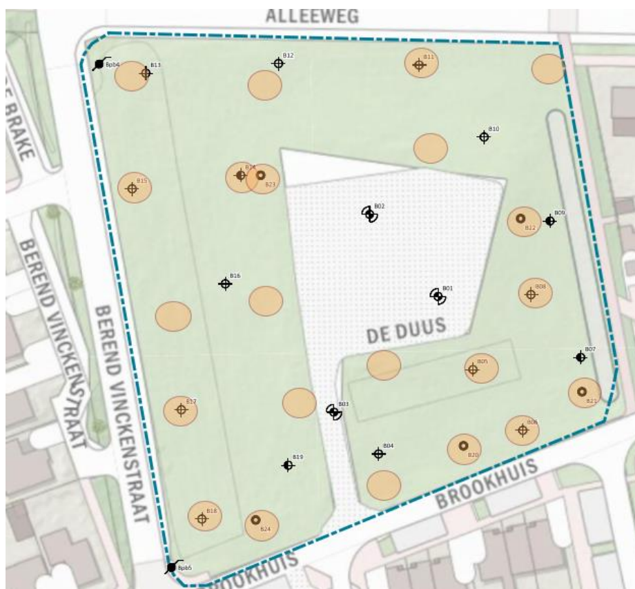
Figuur 2.3: Overzichtstekening met eerder uitgevoerde boringen, waarbij de boringen met een oranje cirkel grond betreft waar puin in is aangetroffen.
