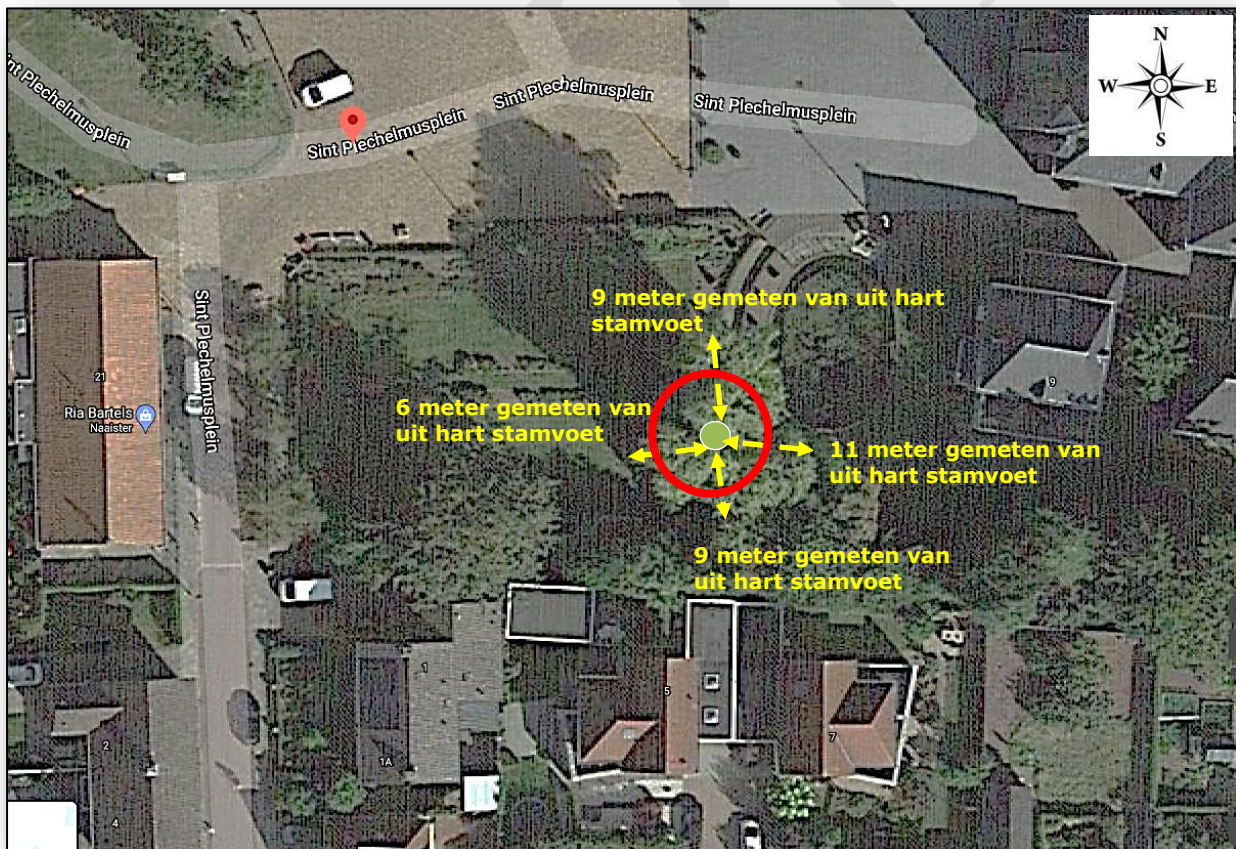
Afb. 10; De maatvoeringen van de huidige kroonprojectie is in alle windrichtingen weergegeven. De maximaal graafafstand gemeten van uit het hart van de boom bedraagt vijf meter e.e.a. zoals indicatief met rood is weergegeven.
