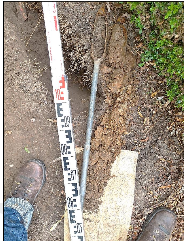
Afb. 9; Vanaf -60 cm is het profiel voortgezet met een edelmanboor.
