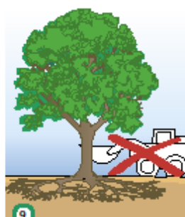
9 Rijd nooit met zwaar materiaal over de wortelkult. Dit leidt tot verdichting en versteking van de bodem met wortelstorte als gevolg. Is dit onvermijdelijk, plaats dan sloopplaten op een bed van grof zand.
