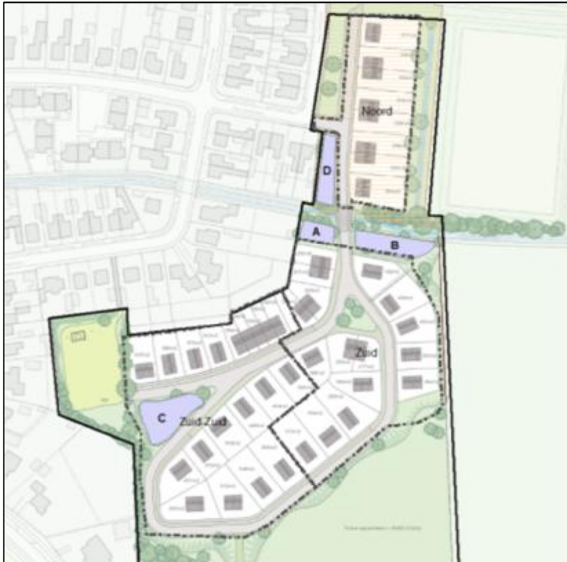
Figuur 15: locatie van de bergingsvoorzieningen weergegeven met een hoofdletter. De grijze gestippelde lijn geeft de begrenzing van de afvoervakken weer (Noord, Zuid en Zuid-Zuid).
