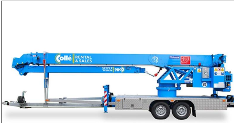
Voorbeeld van een lichte, mobiele kraan. Geschikt voor aanreiken van dakpannen, kozijnen, glas en dakleer.
