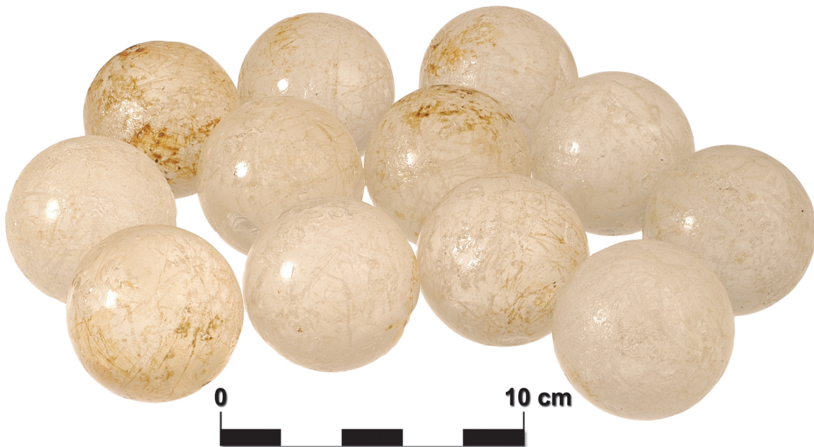
Afbeelding 5.16 | Een dozijn glazen kogels, onderdeel van het lagermechanisme van de compenseerschijf.
