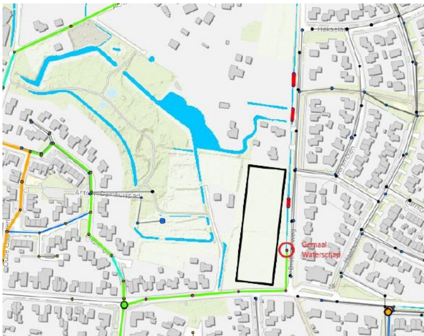
Figuur 6 Bestaande riolering (Noaberkracht, 2022)
