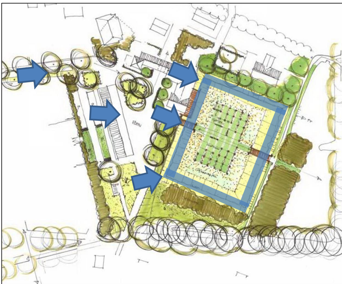
Figuur 3.3: Afvoerrichting hemelwater (blauwe pijlen) richting wadi (blauw) rondom hoptuin.
