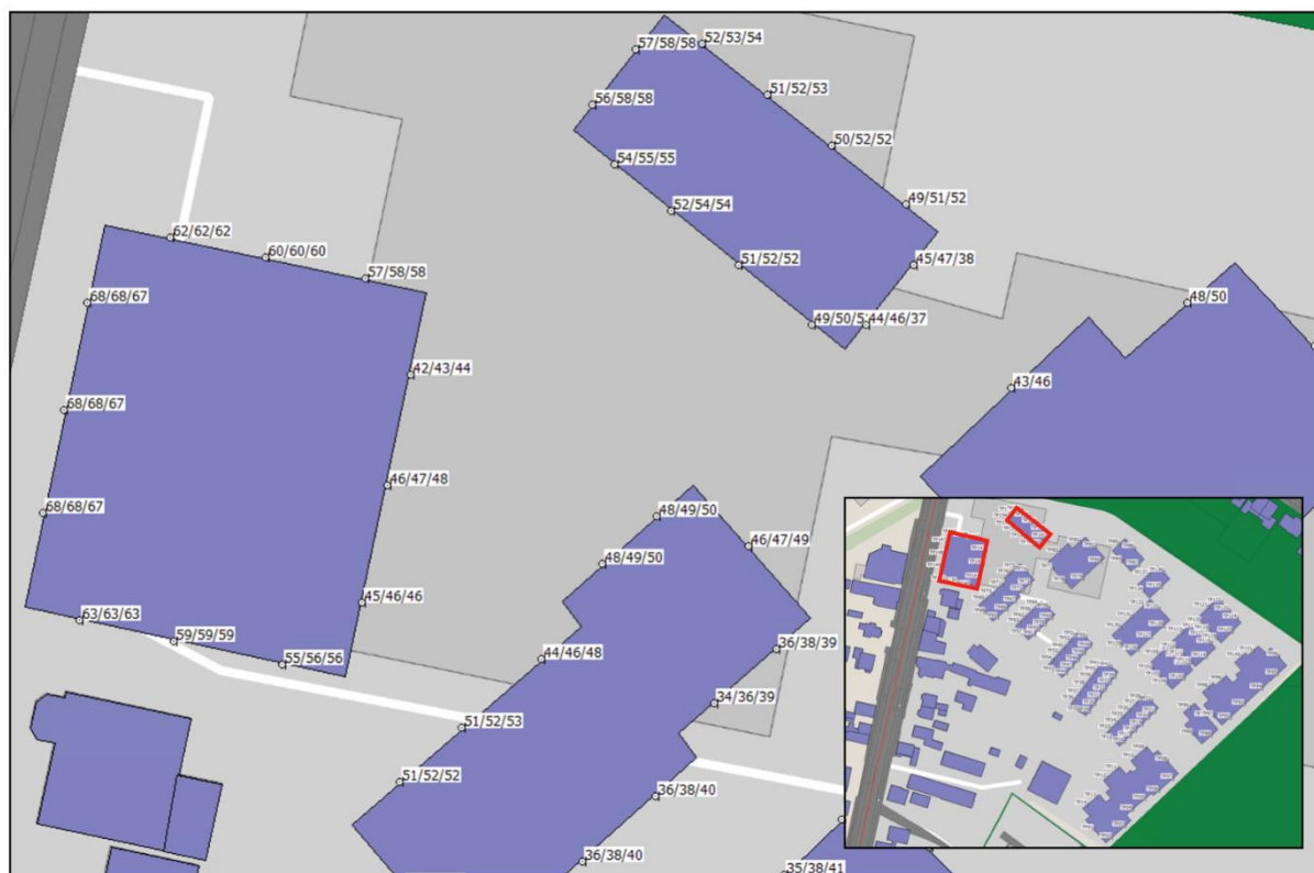
Afbeelding 4.2 Woongebouwen zonder geluidluwe gevel (Bron: Geomilieu, BJZ.nu)
