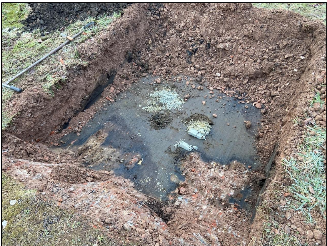
Figuur 10. Boring in kijkgat in het oostelijke deel van het plangebied. De bodem bestaat in deze zone uit kleiig zand, die kunnen worden geïnterpreteerd als beekafzettingen.
