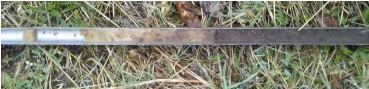
Figuur 20: Foto van boring 6 met rechts de bouwvoor en links daarvan de menglaag die naar beneden toe overgaat in schoon, licht geoxideerd zand.
