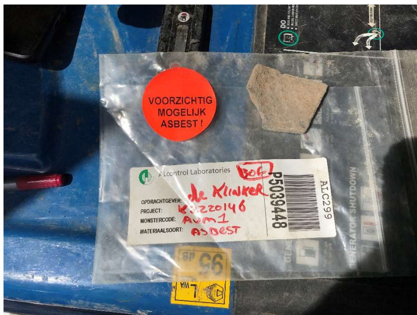
Asbestverdacht materiaal aangetroffen op het maaiveld
