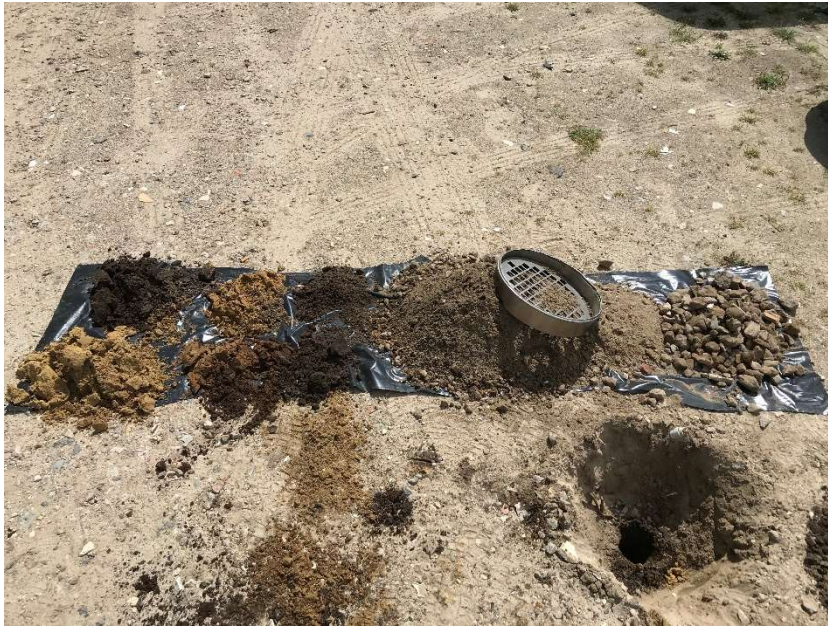
Asbestgat G5 (doorgezet tot 2,0 m-mv)
