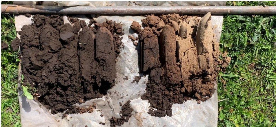
Boring 1: 0-55 cm = het bouwlanddek, vanaf 55 cm = de BC-horizont, vanaf 65 cm = de C-horizont.
