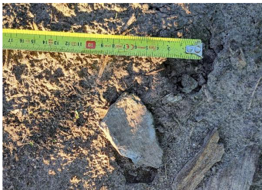
fragment golfplaat op maaiveld t.p.v. proefgat 43
