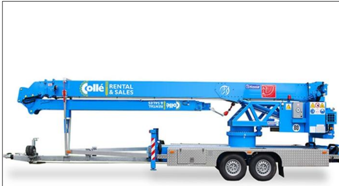
Voorbeeld van een lichte, mobiele kraan. Geschikt voor het aanreiken van zinken dakplaten, kozijnen en glas.
