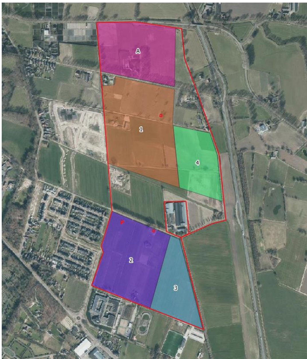
Figuur 1.2 Fasering van de werkzaamheden binnen het plangebied (rood omlijnd). Er wordt gestart met de fase 1 (bruin) en 2 (paars). Na afronding van fase 1 en 2 volgt fase 3 (blauw) en 4 (groen). Uitvoering fase A (roze) is onbekend en afhankelijk van de vraag naar woningen.
