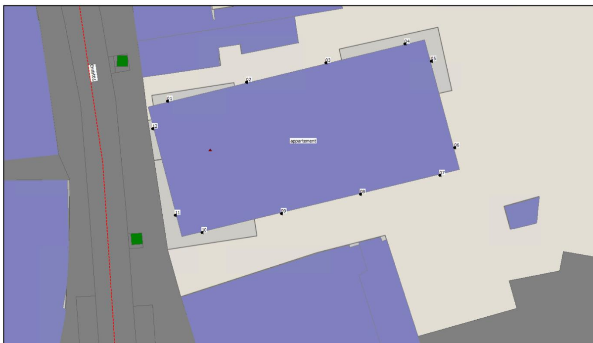
Afbeelding 4.1 Geplaatste toetspunten op de gevels (Bron: Geomilieu, BJZ.nu)
