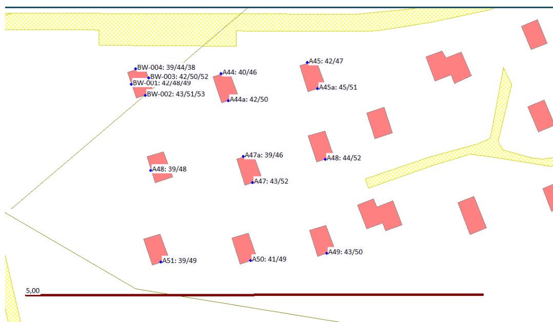
Figuur 10 Geluidsbelastingen vanwege railverkeer met 5 meter hoge afscherming
