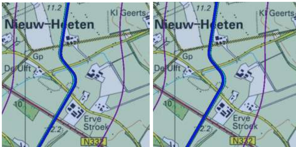
Figuur 3.3: PR 10^{-8} -contour (paars) van leiding A-523 (links) en leiding A-529 (rechts)
