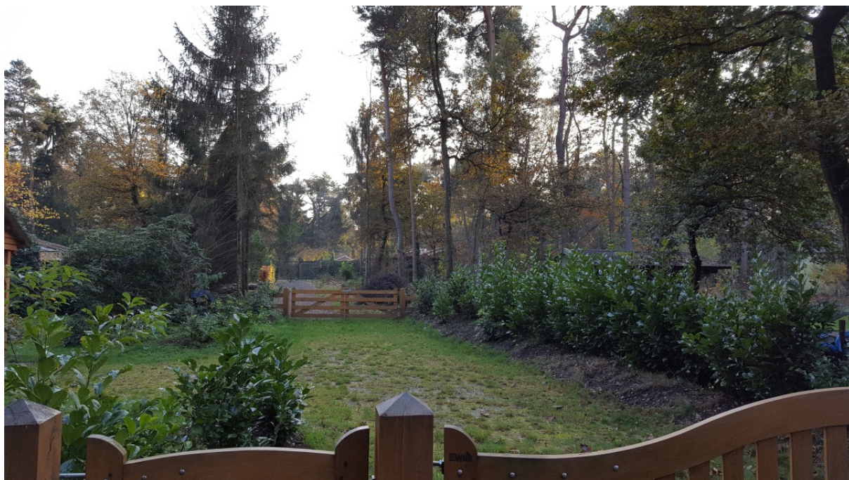
Gerealiseerde brandgang M. Brandgang over twee percelen met telkens hekken bij iedere perceelsgrens. De hekken kunnen bij een calamiteit door de hulpdiensten worden geopend. Door het gras heeft de brandgang weer een groene uitstraling.
