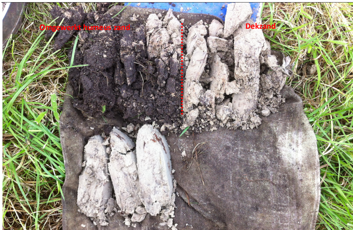
Opname van boring 2. Omgewerkt dek op (verspoeld) dekzand, uitgelegd per 50 cm
