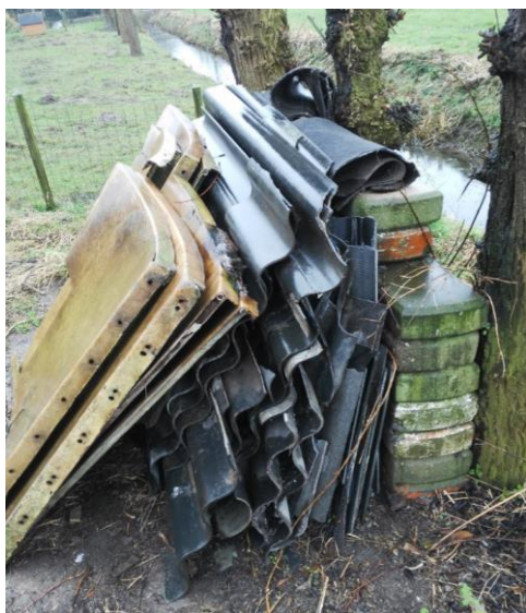
Afbeelding 4: kleinschalige opslag van beschadigde NT golfplaten
