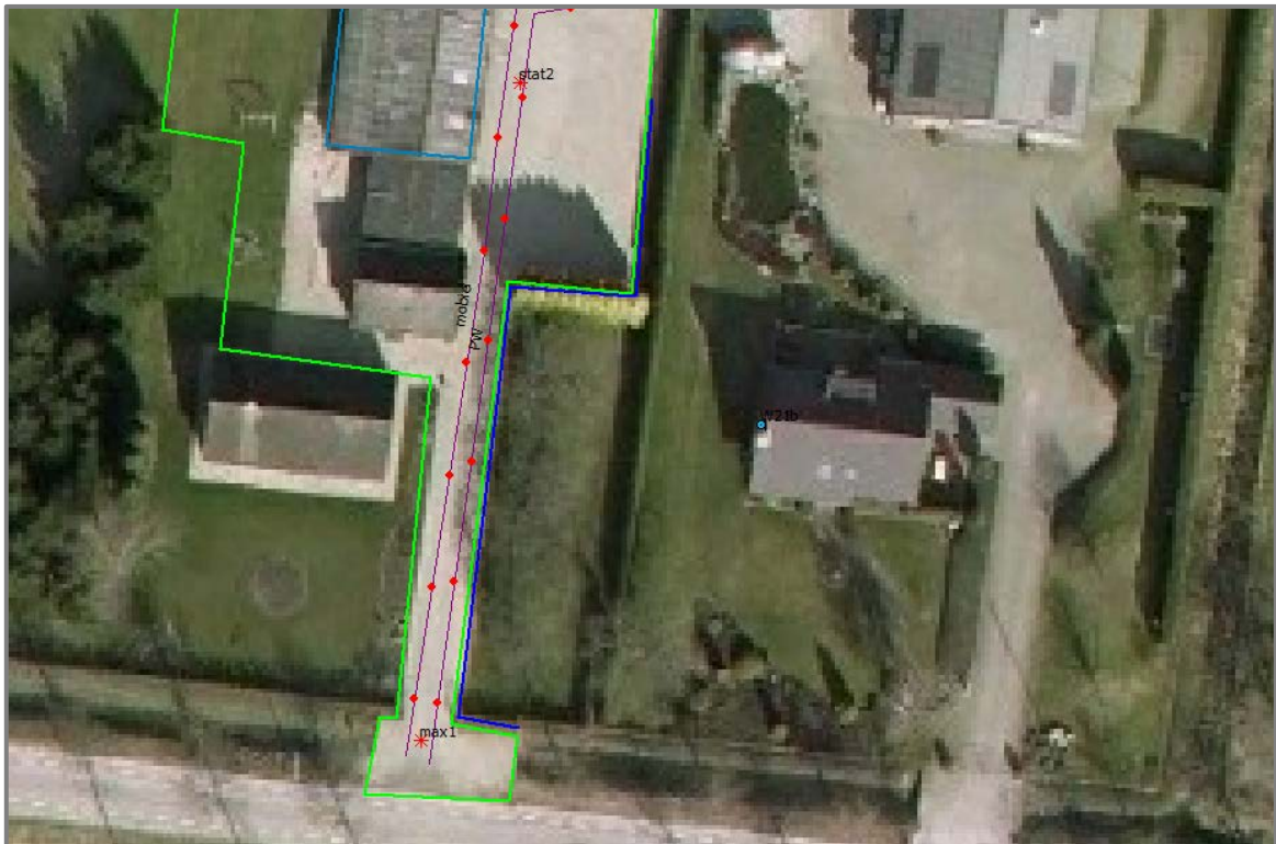
Figuur 3.1 Afschermende voorziening ten behoeve van reductie maximale geluidniveau (blauw)
