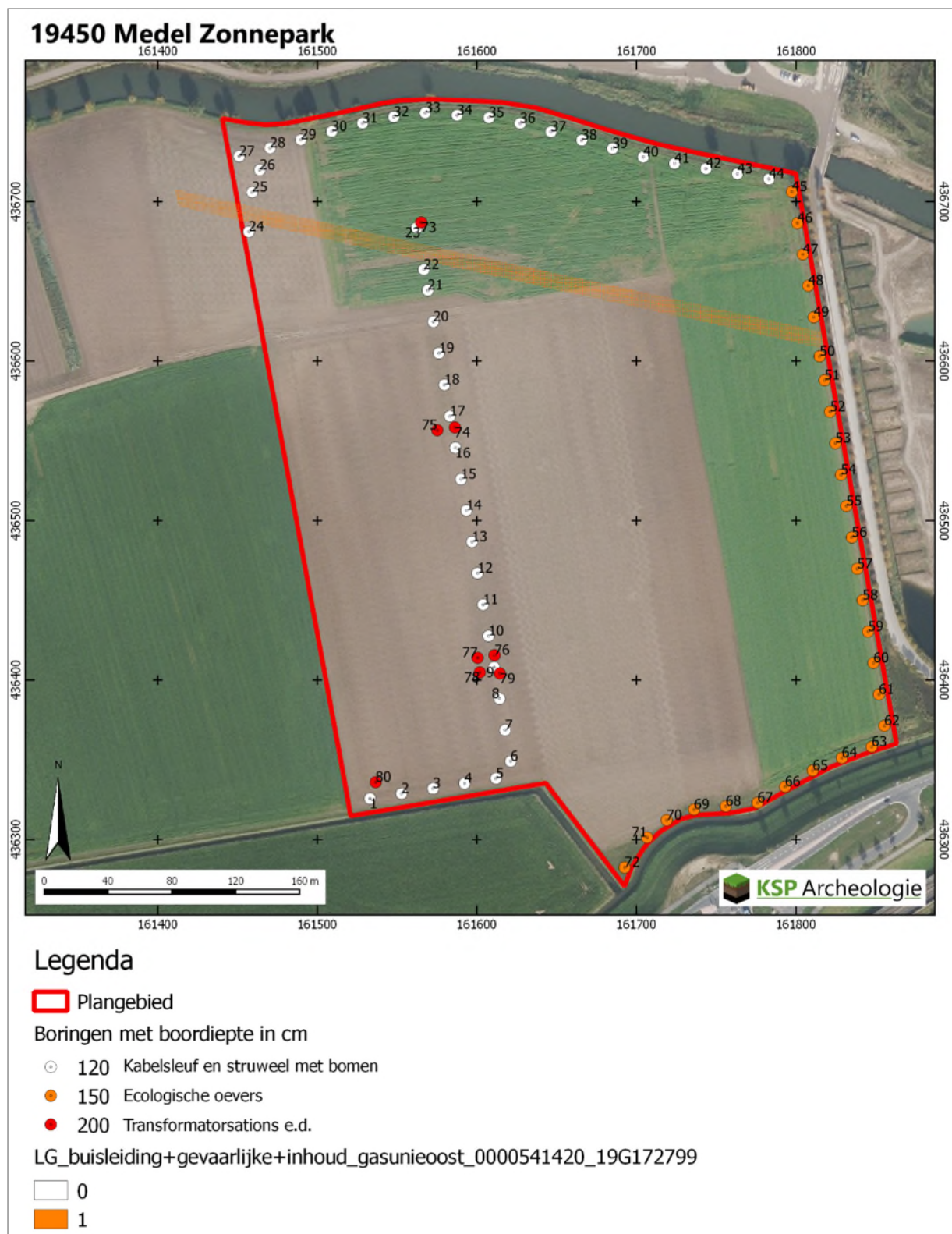
Figuur 5: Overzicht van de boringen met bijbehorende boordiepte.
