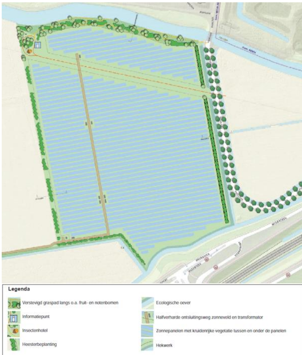
Afbeelding 4: Weergave inrichtingstekening (overzicht) van het zonneveld
