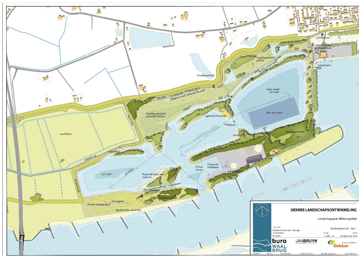
Figuur 10.1 Het Voorkeursalternatief. In tegenstelling tot er basisalternatief zijn er verschillende wijzigingen. Zo wordt de haven kleiner, wordt 6 ha drijvende zonnepanelen voorzien op de Oostplas (in de GO) en blijkt overdraai van de oostelijke windturbine boven GNN toch niet geheel voorkomen te worden. Zie voor de vermoedelijke windturbine-posities de twee lichtgele stippen op het bedrijventerrein.
