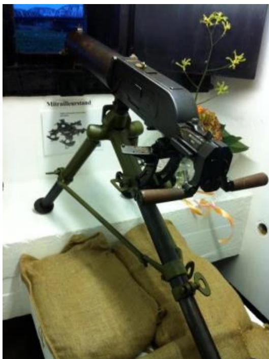
Afb. 27 Mitrailleur type M'08.15 Schwarzlose, kaliber 7.9 mm in kazemat Grave Noord. Rechts reconstructie van een veldopstelling.
