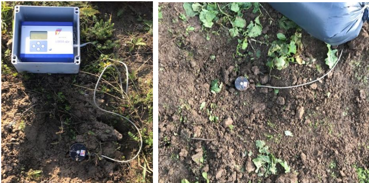
Figuren 4 en 5: foto's van de ondergrondse posities van de geofoons.
