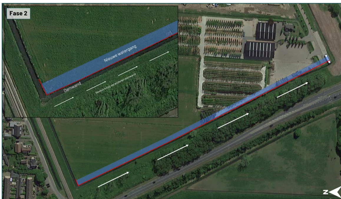
Figuur 3.3 Visualisatie van de locatie van de damwand, nieuw uitgegraven watergang en de werkrichting bij verwijdering hiervan (fase 2).
