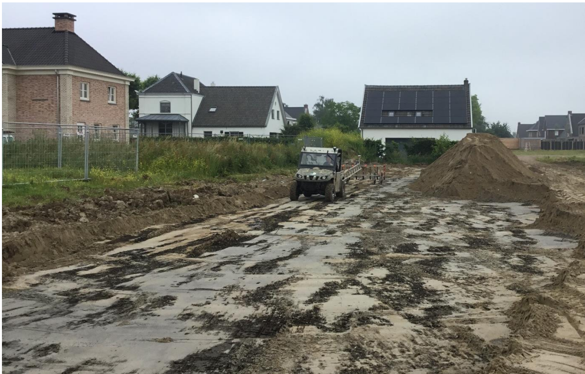
Figuur 2: 8-kanaals meetsysteem voortgetrokken door een 4x4 voertuig.
