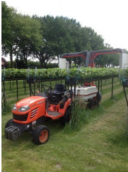
Figuur 3.3: Voorbeeld smalspoortrekker ten behoeve van bespuiten stellingenteelt
