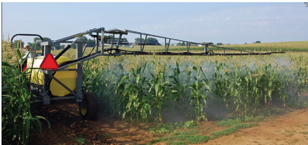
Figuur 3.2: Voorbeeld neerwaarts gerichte bespuiting bij vollegrondsteelt
