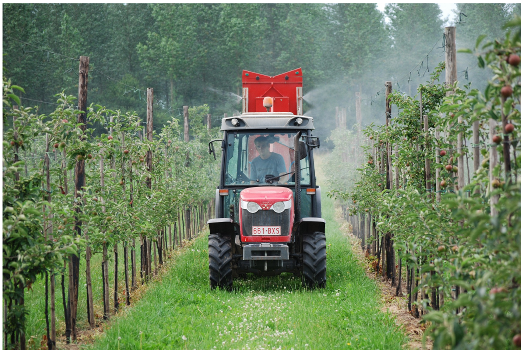
Figuur 3.6: Voorbeeld dwarstroomspuit fruitbomen (rechts normale spuitdoppen, links 75% driftreductie)
