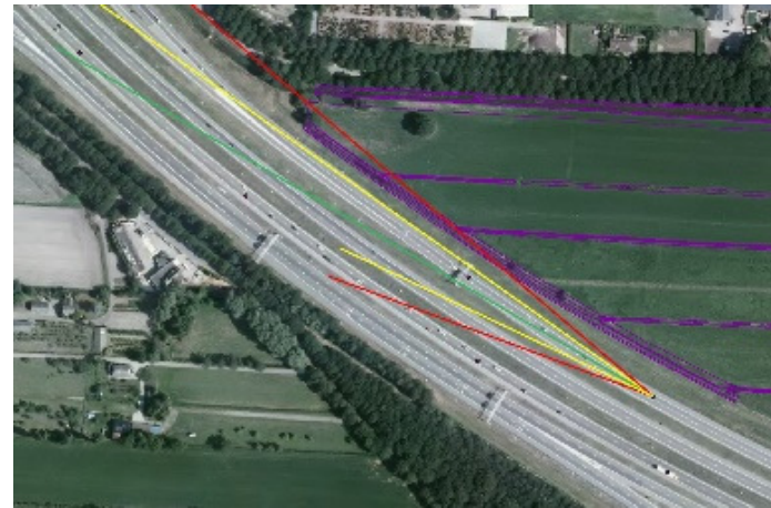
Figuur 1 Visualisatie van de kijkrichting van de doorgaande weg (groene lijn), met kijkhoek van 10 graden (gele lijnen) en kijkhoek van 20 graden (rode lijnen).
