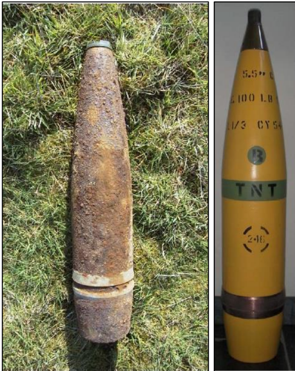
Figuur 11. Brisantgranaat 5.5 inch, 80 lb. (links) en een brisantgranaat 5.5 inch, 100 lb. (rechts).
