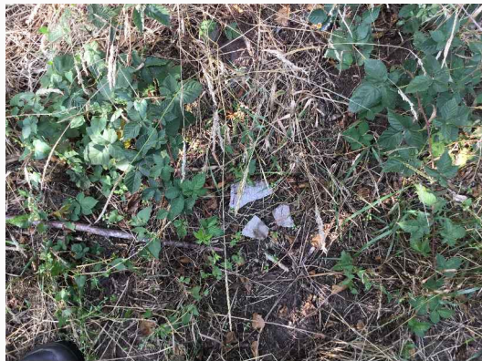
Asbestverdacht materiaal op maaiveld
