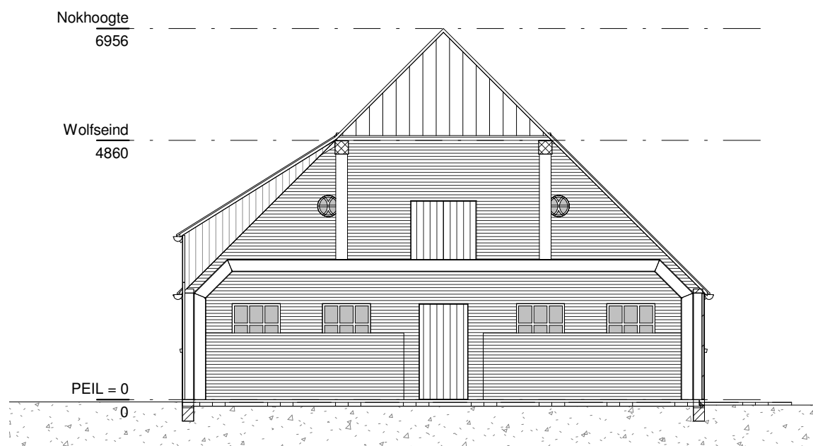
DWARSDOORSNEDE (bestaand) schaal 1 : 100
