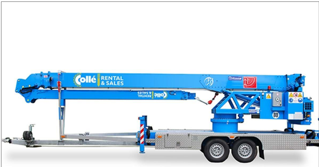
Voorbeeld van een lichte, mobiele kraan. Geschikt voor o.a. het aanreiken van dakpannen, sandwichpanelen, kozijnen en glas.
