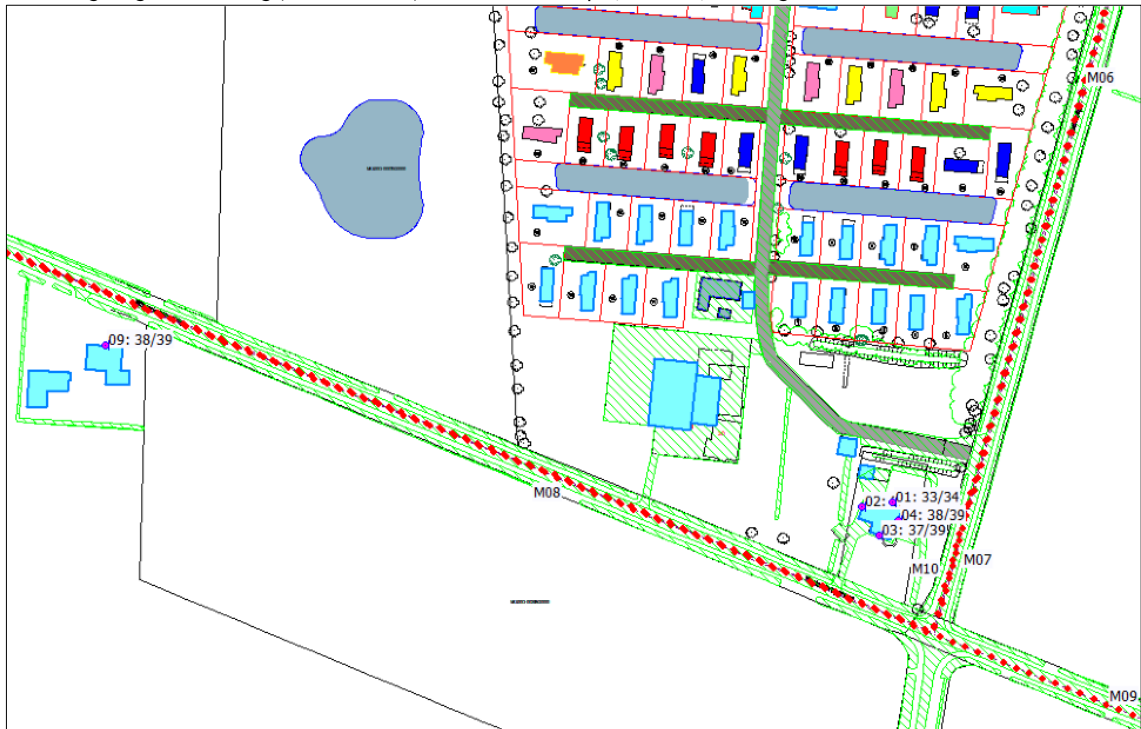
Afbeelding IV: geluidbelasting (etmaalwaarde) indirecte hinder op 1,5 m en 5,0 m hoogte
