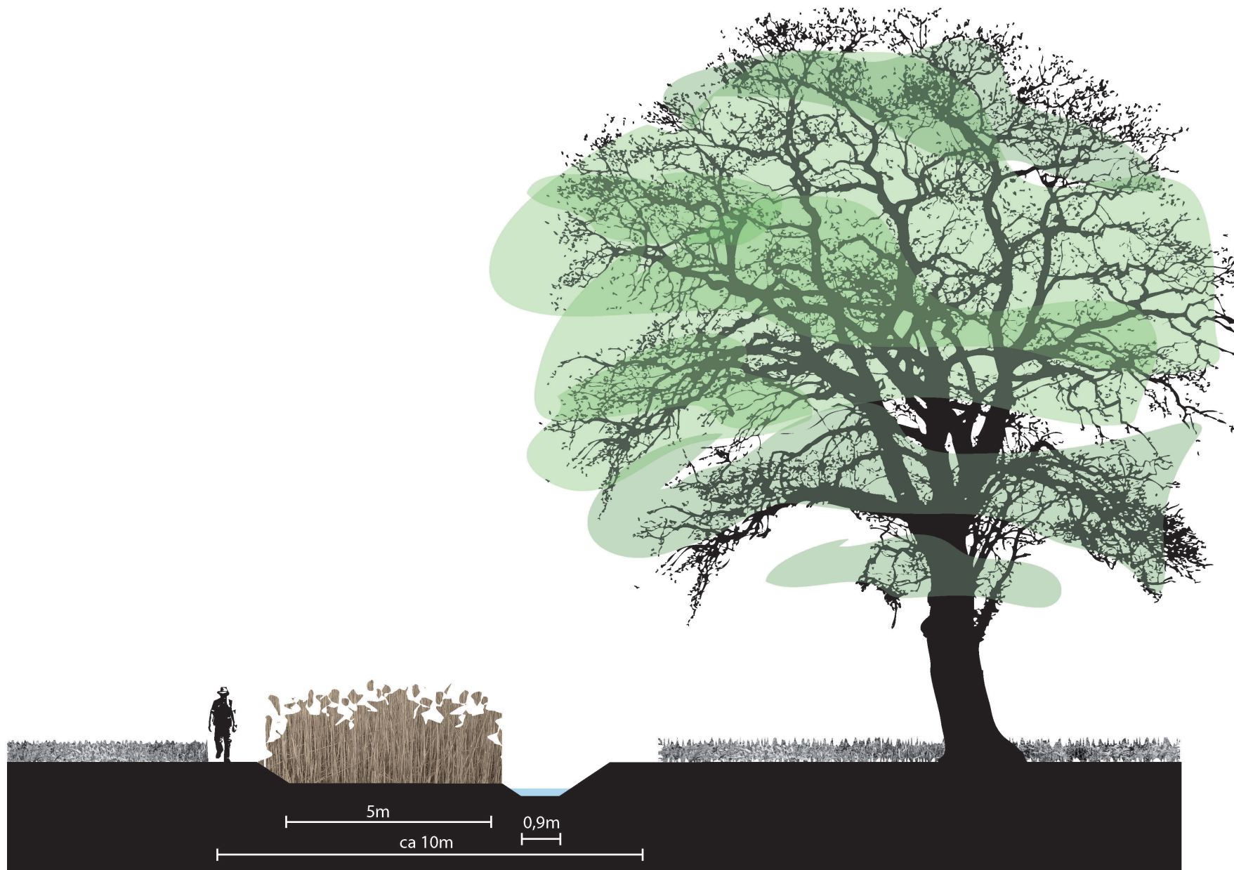
afb. 11 | Principe profiel Nieuwe Hagmolenbeek
