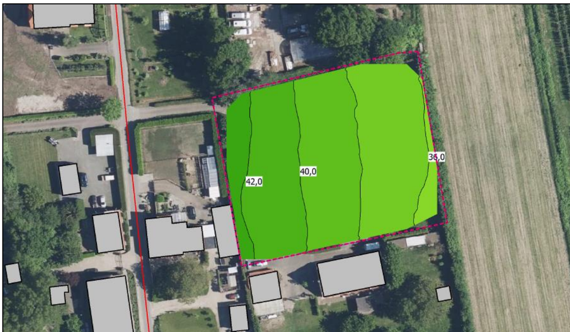
Figuur 4.1: Berekende geluidbelasting vanwege de Noordhoeksestraat op 7,5 meter hoogte (incl. aftrek 5 dB)
