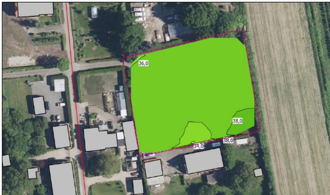
Figuur 4.3: Berekende geluidbelasting vanwege de Boltweg op 4,5 meter hoogte (incl. aftrek 5 dB)
