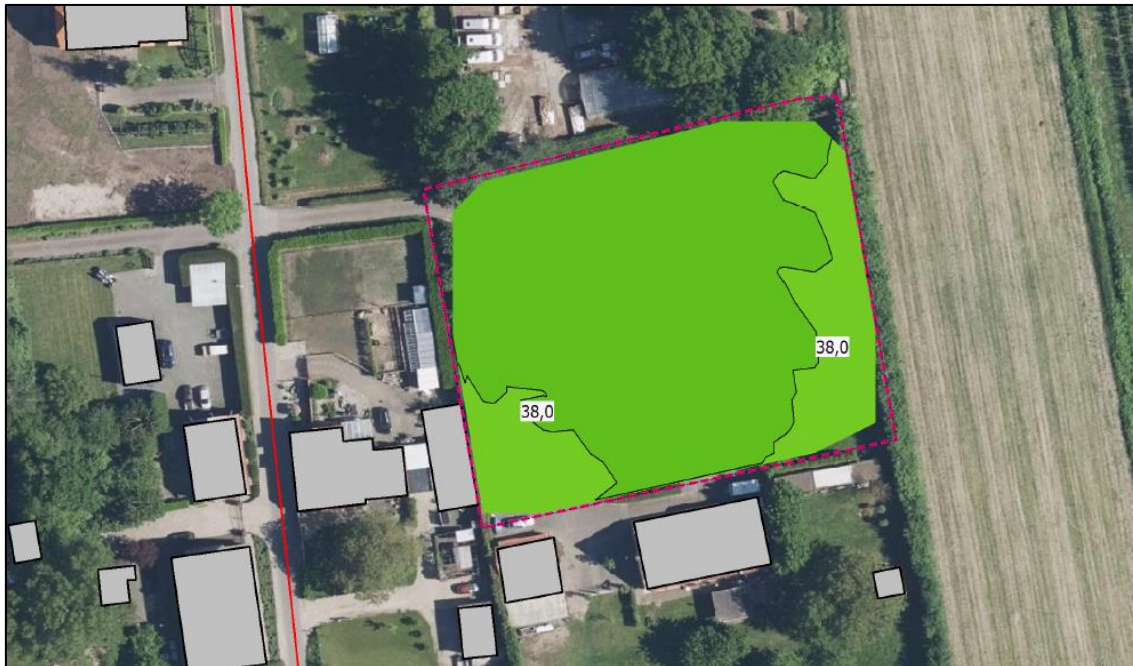
Figuur 4.2: Berekende geluidbelasting vanwege de Drielse Rijndijk op 4,5 meter hoogte (incl. aftrek 5 dB)
