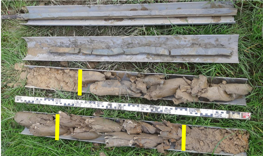
Afbeelding 16: Boring 7 met van onder naar boven de bouwvoor, roestige komlei, crevasse-afzettingen en ongerijpte komlei
