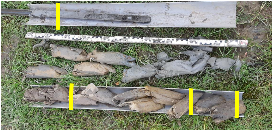
Afbeelding 17: Boring 19 met van onder naar boven de bouwvoor, roestige komlei, een bruingrijze vegetatiehorizont, ongerijpte komlei en oeverafzettingen
