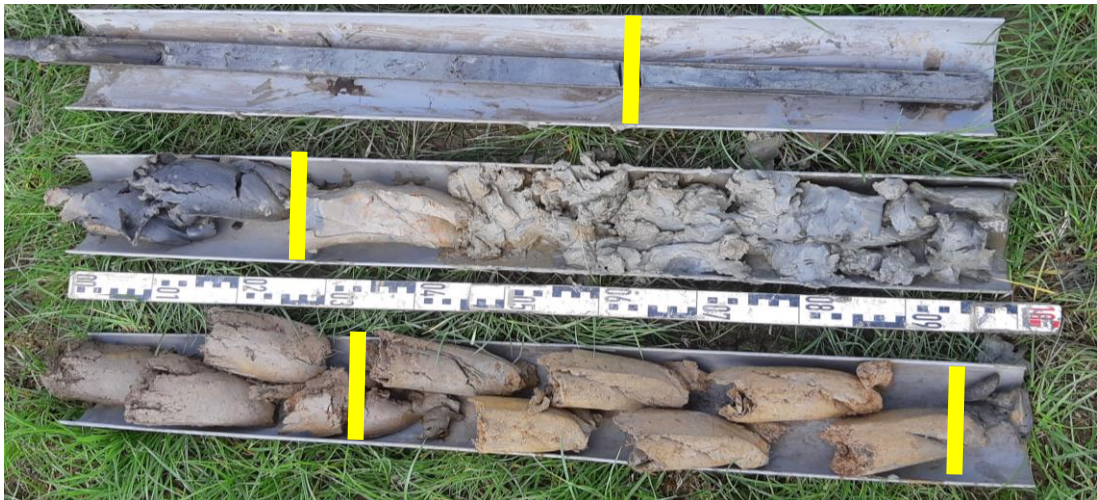
Afbeelding 15: Boring 6 met van boven naar onder de bouwvoor, iets roestige komafzettingen, een donkere bruinrijze vegetatiehorizont, ongerijpte komzettingen en oeverafzettingen
