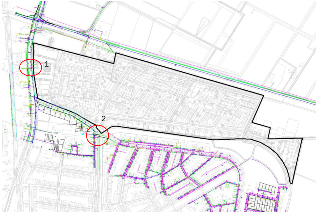
Figuur 2.3 Bestaande kabels en leidingen
