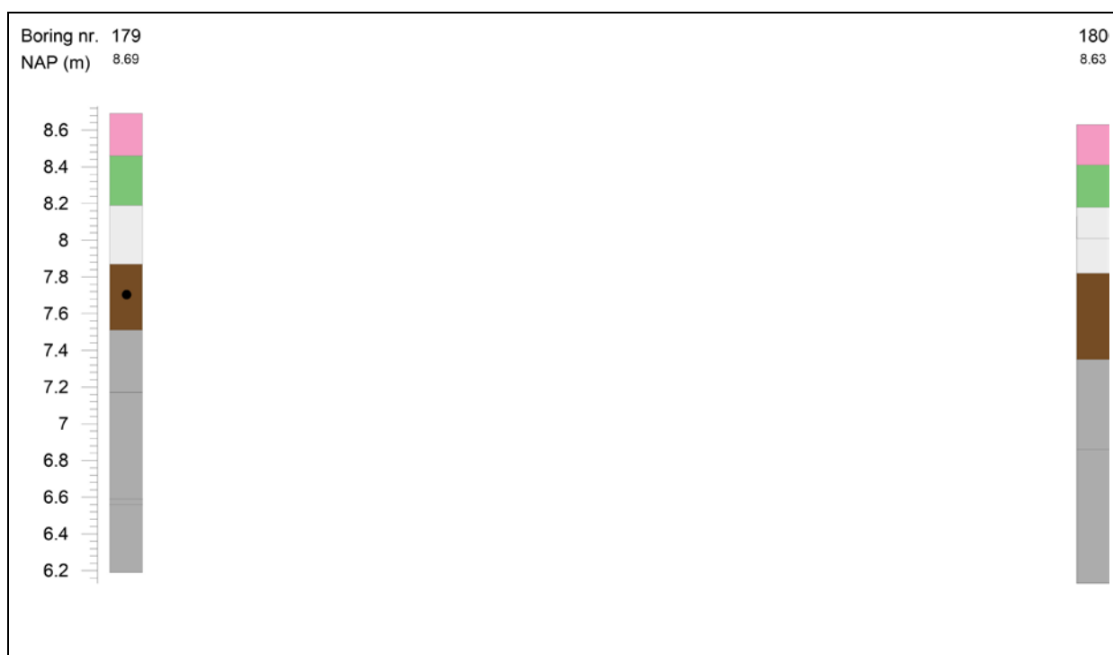
Afbeelding 21. Grafische weergave van Boring nr. 179 en 180.
